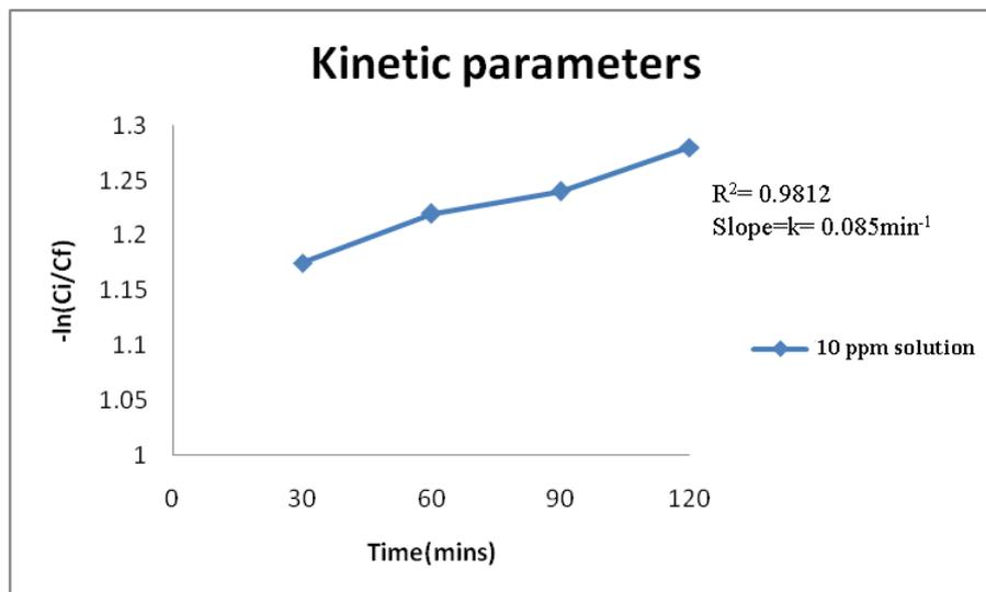
**Fig 5:** Kinetic parameters for IC dye
